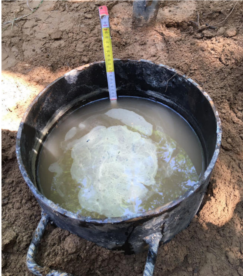
Figura 2: Attrezzatura di prova – infiltrometro ad anello singolo con maniglie per l’infissione nel terreno
